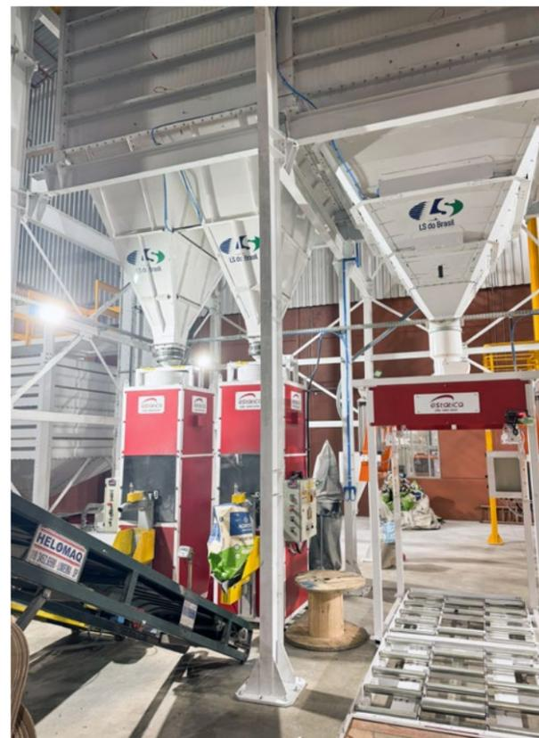
Totalmente automatizada, a nova CTS garante eficiência desde a aferição de dosagem até a pesagem e o tratamento das sementes, operando no sistema batelada com capacidade de 36 toneladas por hora. O espaço conta com duas máquinas: uma com capacidade para 30 toneladas/hora, voltada a grandes volumes, e outra com capacidade para 6 toneladas/hora, destinada a atender demandas específicas, como áreas menores de plantio ou finalizações de semeadura, proporcionando maior agilidade ao produtor.
